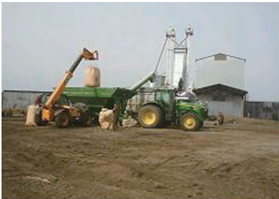
곡물이송기를 이용한 트럭 상차
